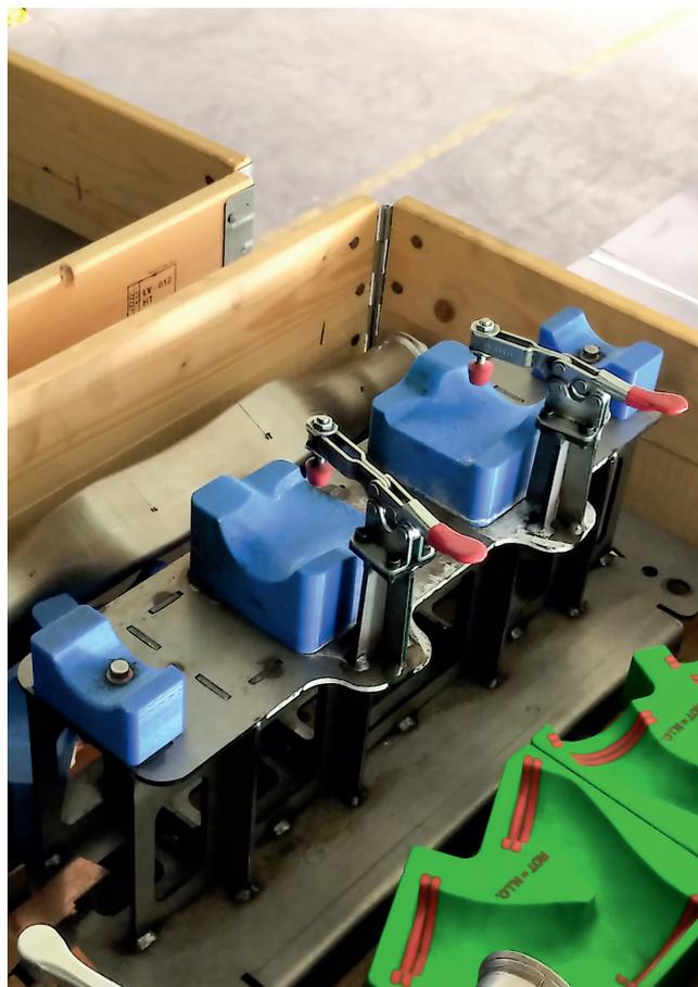
**3D-Druck im Werkzeugbau:** Mit dem 3D-Drucker F170 kann Mawe Presstec flexibel Vorrichtungen fertigen und diese anpassen und adaptieren.
